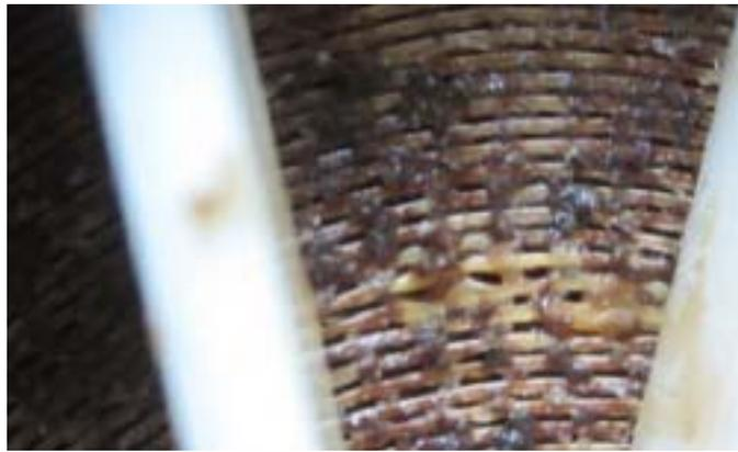
嚴重的膠體污染一般很難清洗，針對不同的膠體污染需根據實際情況採用不同的清洗方案。詳情可參考：第三章《膜系統清洗》。膠體污染發生時，首要確認預處理（多界質過濾器、超濾系統）系統等是否存在失效或超負荷情況，並根據實際情況來對預處理系統進行優化。
