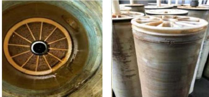
當顆粒污染發生時，需立即檢查預處理是否完善，原水是否存在突變情況；並根據實際情況進行相應處理措施，確保膜系統進水滿足進水水質要求。詳請可參考：第五章《膜系統進水水質要求》。
