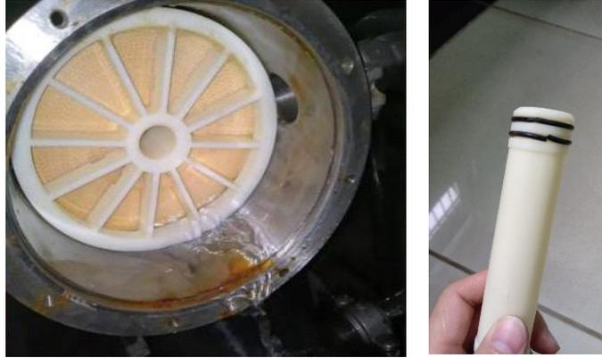
O型圈洩漏主要為膜元件安裝時密封圈潤滑不良或膜元件安裝不當（膜元件在膜殼中滑動）造成。
