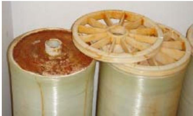
鐵污染一般可採用檸檬酸或連二亞硫酸鈉來針對清洗。詳情可參考：第三章《[膜系統清洗](#)》。對於金屬氧化物污染，需要根據實際情況採用錳砂過濾等氧化—過濾設備或其它去除金屬氧化物的預處理方法。
